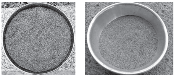
Hình 3. Thành phẩm mụn dừa đã cứng hóa bằng xi măng (nguồn: tác giả)
